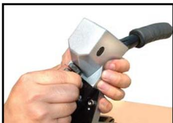
Ослабьте регулировочную гайку (011) и поверните регулировочный винт (010) по часовой стрелке (вкрутите), чтобы ослабить сжатие. Для усиления сжатия скобы, поверните винт (010) против часовой стрелки. После регулировки затяните гайку.
