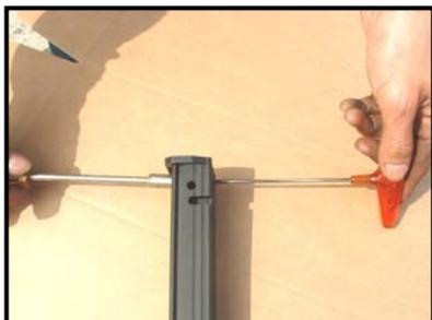
Открутите винты (517) и гайку (516) шестигранником 2.5мм и ключом 7мм.
