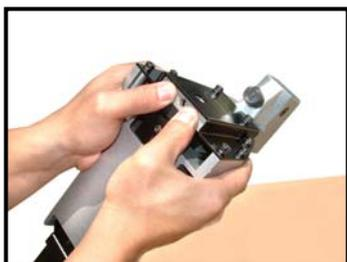
Подвиньте корпус (001) вверх и установите желаемое заглубление.
