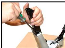
Снимите магазин (023) с помощью шлицевой отвертки. Выполните чистку.
