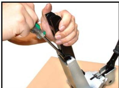
Снимите магазин (023) при помощи плоской отвертки.
