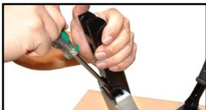
Снимите магазин (023) при помощи плоской отвертки.
