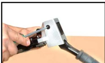
Открутите болт (006) шлицевой отверткой. Снимите рукоятку и соединяющий механизм.
