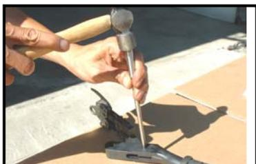
Выбейте шпильку (501) с помощью молотка и 5мм прямого стержня.
