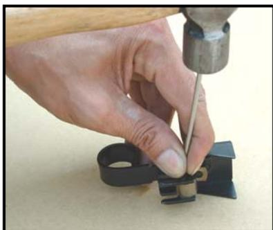
Выбейте шпильку (520) молотком и 4мм стержнем.
