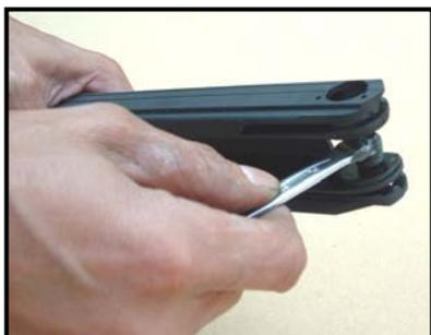
Открутите рейку (031), снимите направляющие толкателя (032) и снимите толкатель (026).
