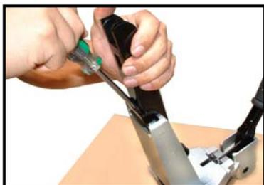
Снимите магазин (023) при помощи плоской отвертки.
